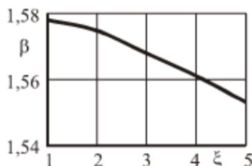
Рис.4.13. Зависимость коэффициента \beta от коэффициента неравномерности кольцевого армирования \xi .
